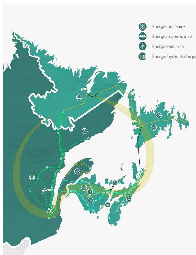
Figure 12.10 : La boucle de l'Atlantique proposée augmenterait la capacité d'importation d'électricité dans les provinces maritimes 75
